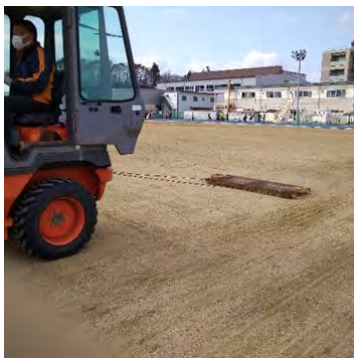
写真2 大型鉄製レイキ 近景 <インフィールドクレイグラウンド>
