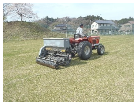
写真 7. パイプシーダー（外注）【近景】 多数の突起の付いた30cmくらいのドラムを振動させながら牽引し、地表面に穴を明けその上に種子を散布していく。
