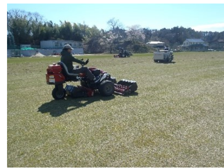
写真 6. 3連乗用リールモア（保有）【近景】 2台の機械操作で葉先の不揃いを調整するために草刈りを実施
