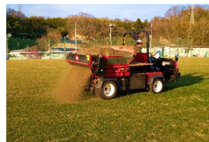
写真 8. 目砂散布機械（保有）【近景】 タイヤシャベルで積み込んだ目砂をホッパーの底部にあるベルトコンベアで後部吐き出し口に送り込み均一に散布する。
