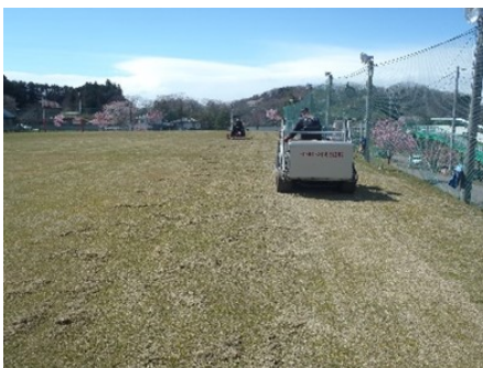
写真 5. スイーパー機械（保有）【近景】 左側奥のバーチカル機械で起こした刈りカスなどを吸い込んで掃除する
